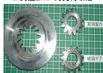
破損ギア新規製作
